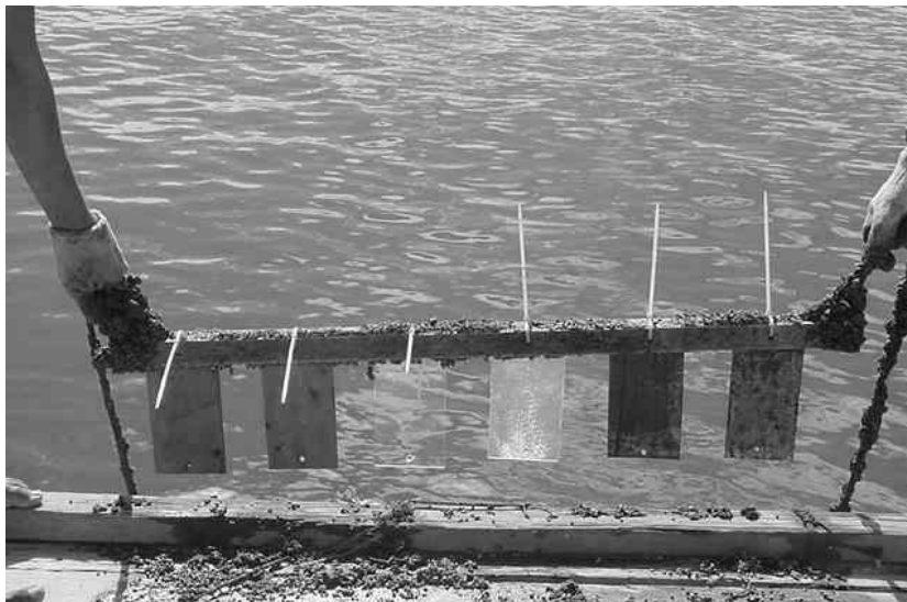
Figura 1 - Suporte de alumínio com as cinco placas estudadas no Porto do Recife, em 2004.
