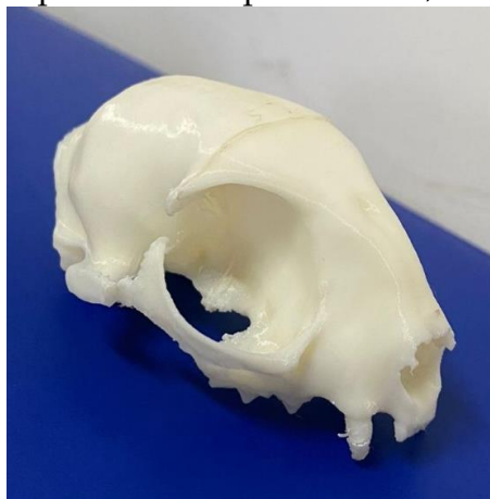
Figura 4 - Crânio de gato impresso em impressora 3D, utilizando filamento PLA
