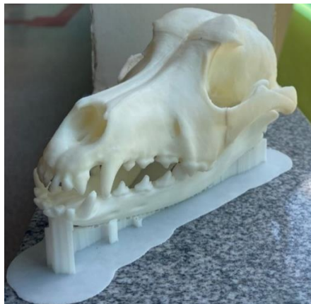
Figura 3 - Crânio de cão impresso em impressora 3D, utilizando filamento PLA
