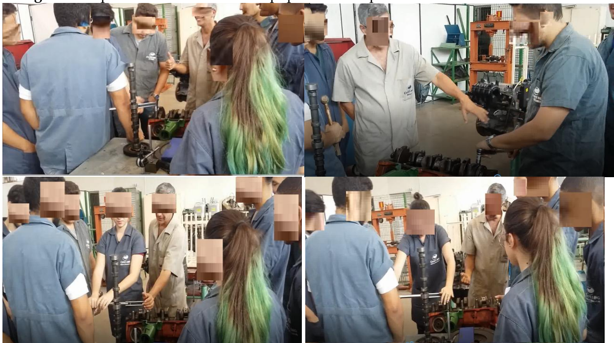
Figura 4: Sequência da aula o uso do equipamento torquímetro no motor
