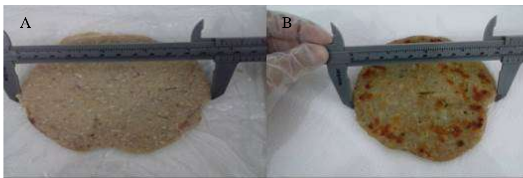
Figura 2. Imagens representativas da realização do teste de encolhimento. (A) Teste de encolhimento sendo realizado antes da fritura, (B) teste de encolhimento sendo realizado após fritura.
