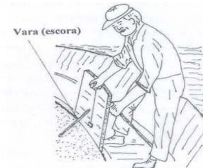
Figura 5 - Construção da parede usando escoramento com varas.
