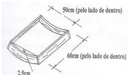
Figura 2 - Forma para fabricação de placas de parede.
