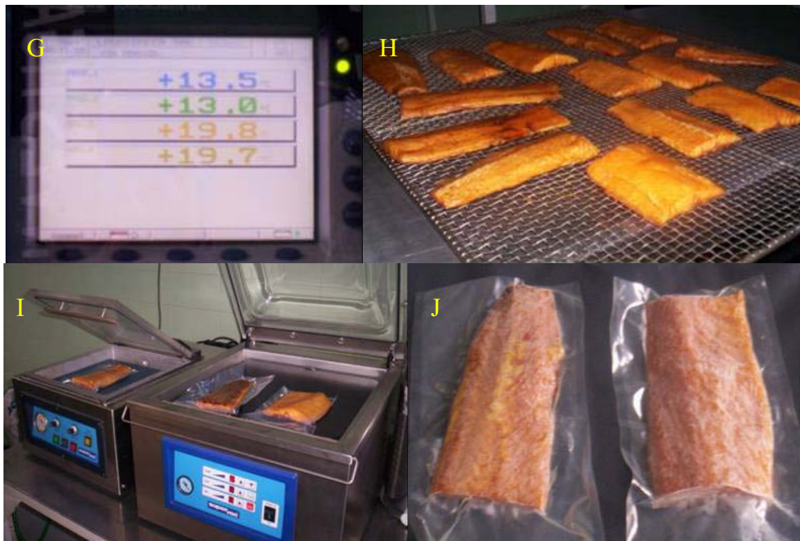
Figura 3 (Cont.) - G) Registro de temperaturas de proceso; H) Filetes ya ahumados; I) Envasado al vacío y J) Producto piloto final envasado al vacío y congelado.
