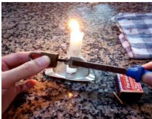
Figura 1. Observando o conceito de dilatação térmica dos sólidos, a chave não entra mais porque ocorreu um aumento das dimensões de um corpo devido a elevação de sua temperatura.
