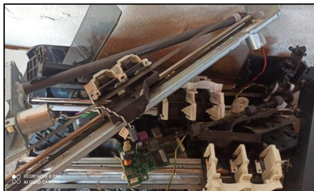
Figura 4. Sucata de impressoras convencionais para a confecção da impressora 3D caseira
